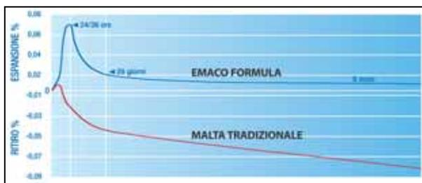
L' EMACO FORMULA FLOWFIBER, sottoposto al test di inarcamento/imbarcamento, evidenzia già dopo 24 ore un inarcamento ( $\cap$ ) del provino che dimostra, in modo semplice ed immediato, l'effettiva capacità del prodotto di garantire espansione contrastata in aria.
