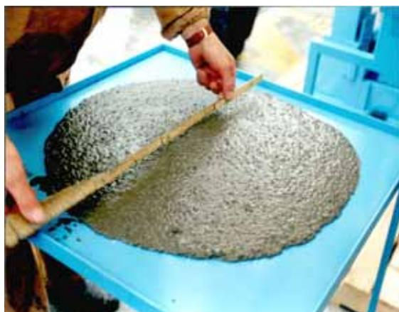
La sua particolare reologia gli consente di autocompattarsi senza necessità di vibrazione;
