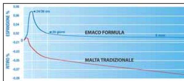
L'EMACO FORMULA REODINAMICO B1, sottoposto al test di inarcamento /imbarcamento, evidenzia già dopo 24 ore un inarcamento ( $\curvearrowright$ ) del provino che dimostra, in modo semplice ed immediato, l'effettiva capacità del prodotto di garantire espansione contrastata in aria.
