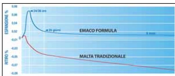
L' EMACO FORMULA TIXO, sottoposto al test di inarcamento/imbarcamento, evidenzia già dopo 24 ore un inarcamento (∩) del provino che dimostra, in modo semplice ed immediato, l'effettiva capacità del prodotto di garantire espansione contrastata in aria.
