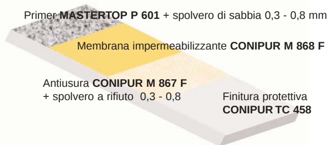
Figura 1. Stratigrafia di CONIDECK 2252
