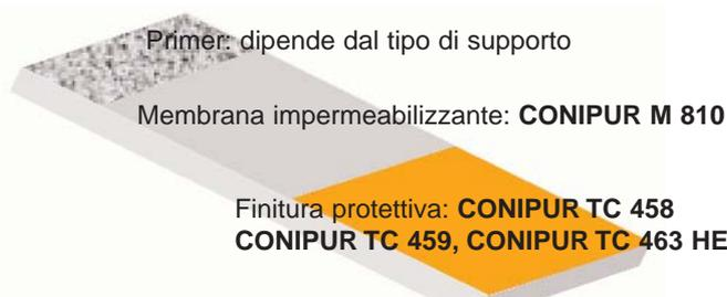
Figura 1. Stratigrafia di CONIROOF 2110
